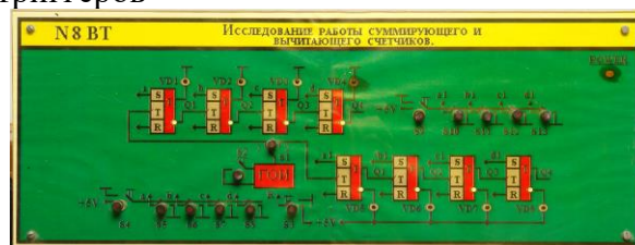
8. Исследование работы суммирующего и вычитающего счетчиков
