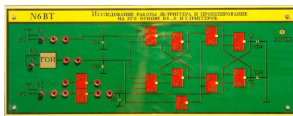
6. Исследование работы JK-триггера и проектирование на его основе RS-, D- и T-триггеров
